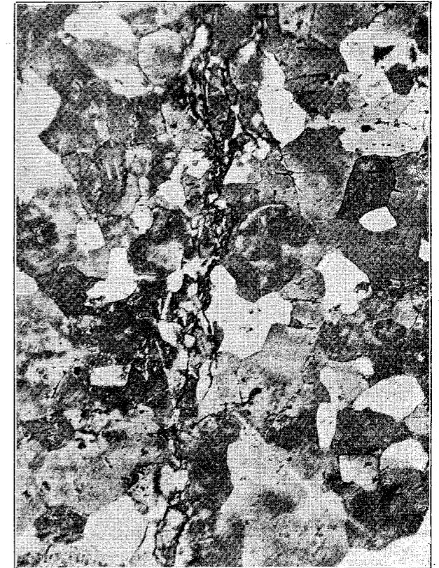
Fig. 141. Træthedsrevne i Traad af blødt Staal. 100 Gange forstørret 1) .
