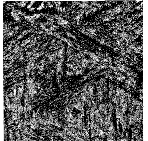
Fig. 114. Martensitstruktur frembragt ved at afkøle Staal med 0,4—0,5 % C i koldt Vand fra ca. 1000^{\circ} . 900 Gange forstørret.
