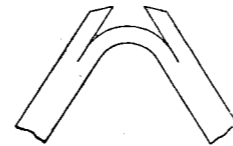
Fig. 95. Bøjelighedsprøve med indkærvet Svejseljærn.
